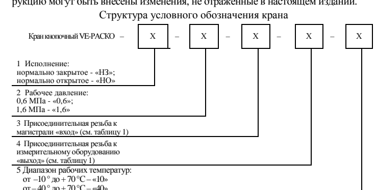
Рисунок А.1 - Кран VE-PACKO нормально закрытого (НЗ) исполнения
